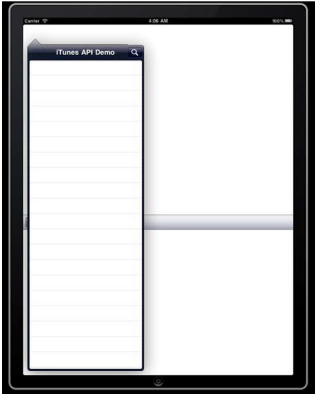
**图 10.20** iPad 应用在竖直方向运行的时候 master view 会以一个弹出框的形式出现
